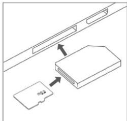
SDカードアダプターを使用してビデオを再生するためには、メモリーカードを取り外して、それをSDカードアダプターに挿入します。アダプターをコンピューターに設置します。
