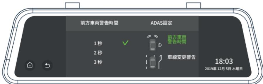
3. 車線変更警告の適切なものを選択します（初期設定の数値になっています）。LCLCWは、車線変更時の警告の感度を示します。高・中・低は、車線変更時間2秒/3秒/4秒にそれぞれ対応しています。
