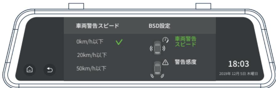
3. 警告感度の適切なものを選択します（初期設定の数値になっています）。警告感度とは、設定した警告範囲で車両が検出された時、後続車両の運転スピードが設定値を超えていた場合に、アラートが有効になります。
