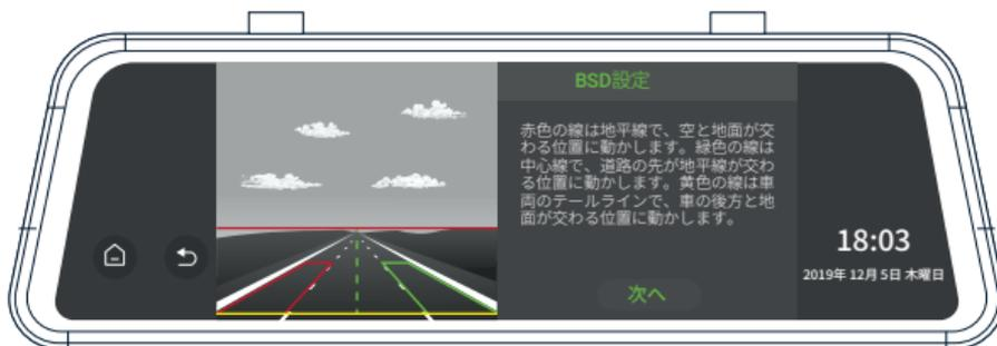
5. 赤色の線を、地平線に合わせて上下に動かします（空と地面の交わる線）。黄色の線を、車の後方と地面が変わるように上下に動かします。緑色の線を、道路の先が地平線が変わるように左右に動かします。適切に調整したら、次へを押して警告範囲の調整に移動します。
